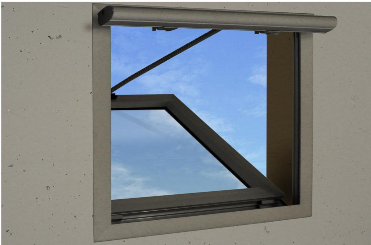
Цепной электропривод модель C160RWA/1000 в элегантном алюминиевом корпусе. Напряжение питания 24В =, тянущее усилие 185 Н, ход цепи 1000 мм. Может устанавливаться на фрамуги в конфигурации "петли снизу, открытие наружу", либо на поворотные створки (петли сбоку).
