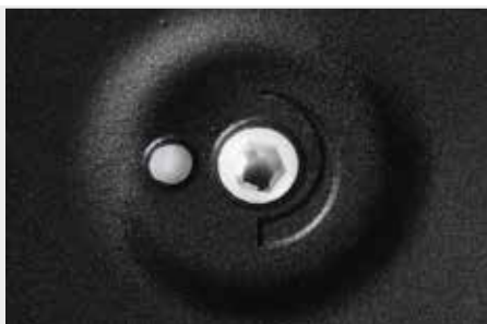
Простая регулировка хода цепи (7 положений от 100 до 500 мм)
